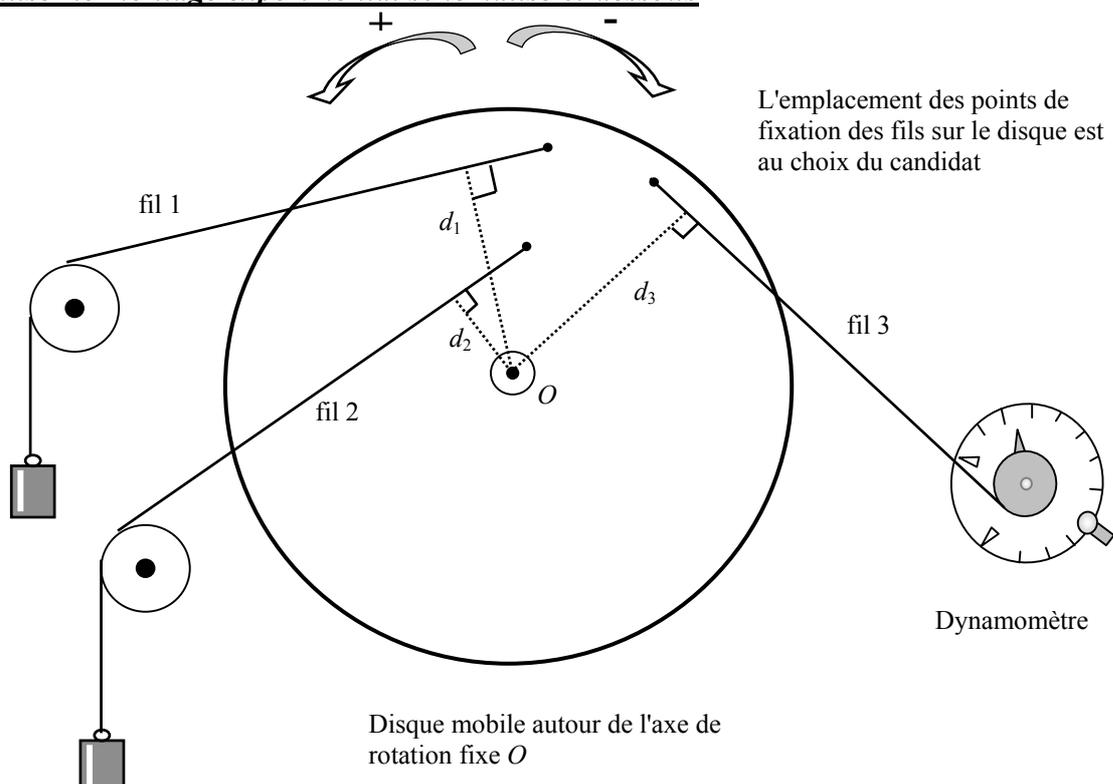
On désigne par  $\vec{F}_1$  la force exercée par le fil 1 sur le disque, par  $\vec{F}_2$  la force exercée par le fil 2 sur le disque, par  $\vec{F}_3$  la force exercée par le fil 3 sur le dynamomètre sur le disque.
